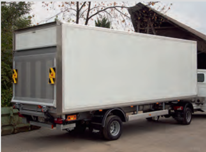
Kofferaufbau Sandwichbauweise / Alu-Klemmbauweise
