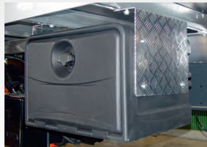
Werkzeugkiste (z.B. 400/600/800 mm) mit Gummidichtung, abschliessbar
