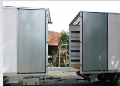
Fronttüren mit Überfahrblech
